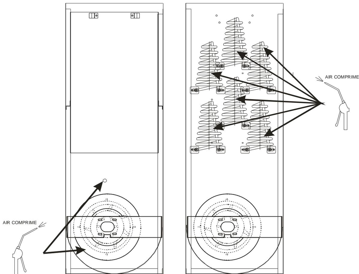
Après nettoyage remettre correctement en place la chambre chaude à l'aide des deux vis. Puis refermer l'appareil à l'aide des trois vis papillon.
