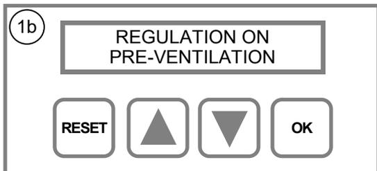
1b- La régulation demande du chauffage, l'appareil commence son cycle d'allumage, il en est au stade de la pré-ventilation de l'échangeur (extracteur des fumées en fonctionnement).
