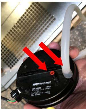
Le capteur de pression doit être équipé de restricteurs de pression rouge **des deux cotés !**
