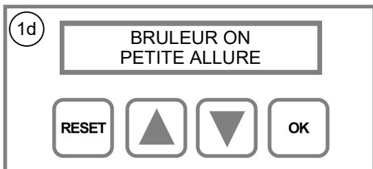
1d- La régulation demande du chauffage en petite allure, l'appareil est en fonctionnement (Brûleur en petite allure).
