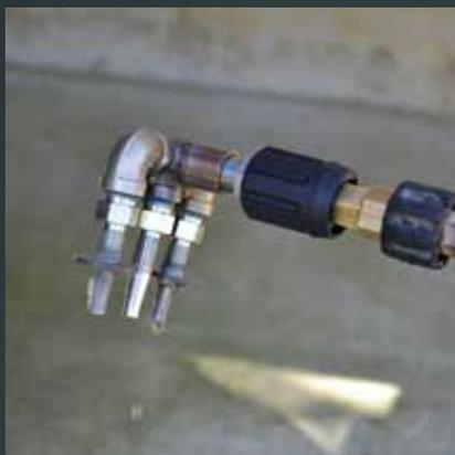
Ce trident permet de nettoyer l'appareil en 30 minutes, soit 10 secondes par M<sup>2</sup>. Adaptable sur n'importe quelle lance de nettoyeurs haute pression.
